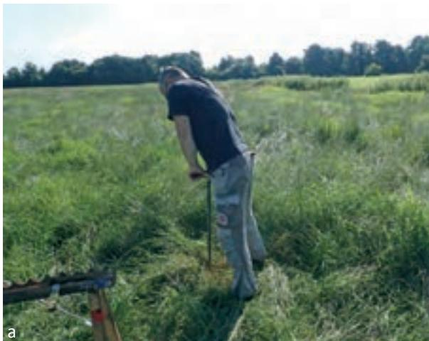
*Mit etwas Glück muss der Bohrstock im Torf in den ersten Metern nicht gehämmert werden, sondern lässt sich einfach in den Boden drücken.*
