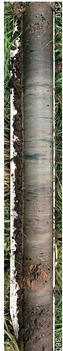
*Bohrkern aus der Ahlenrönne: oben und unten Torf, dazwischen marine Sedimente.*
