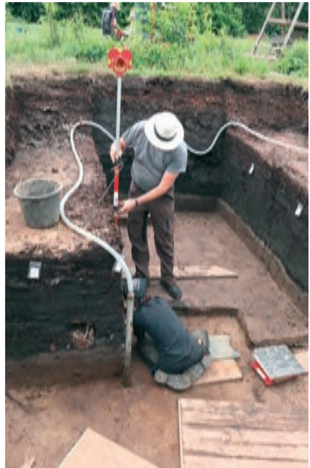
*Damit klar ist, welche Koordinate von der Totalstation weitergegeben werden soll, wird ein Spiegel angepeilt, dessen Standort dann mittels Infrarotmessung genau berechnet wird.*
