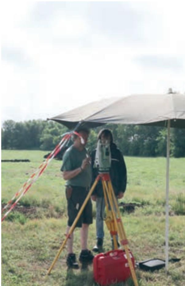
*Mit der Totalstation werden die Koordinaten bestimmt und an einen PC weitergeleitet. Dort werden sie in CAD oder GIS sofort angezeigt.*
