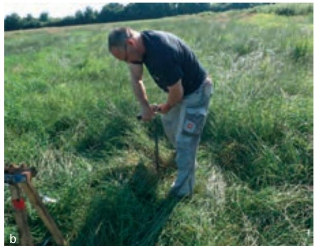
*Um in dem offenen Teil des Bohrers genug Sediment mit hoch zu befördern und Schichtgrenzen erkennen zu können, muss der Bohrer im Boden um die eigene Achse gedreht werden.*
