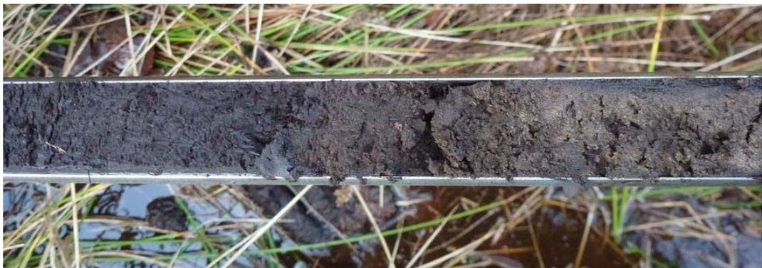
Abb. 5. Torf-Mudde-Übergang im Bohrprofil PR-5 bei ca. 230 cm.
