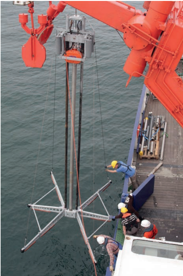
Abb. 1. Ausbringen eines Vibrolots für die Sedimentkerngewinnung auf dem Forschungsschiff Heincke (Foto: Daniel Hepp).
