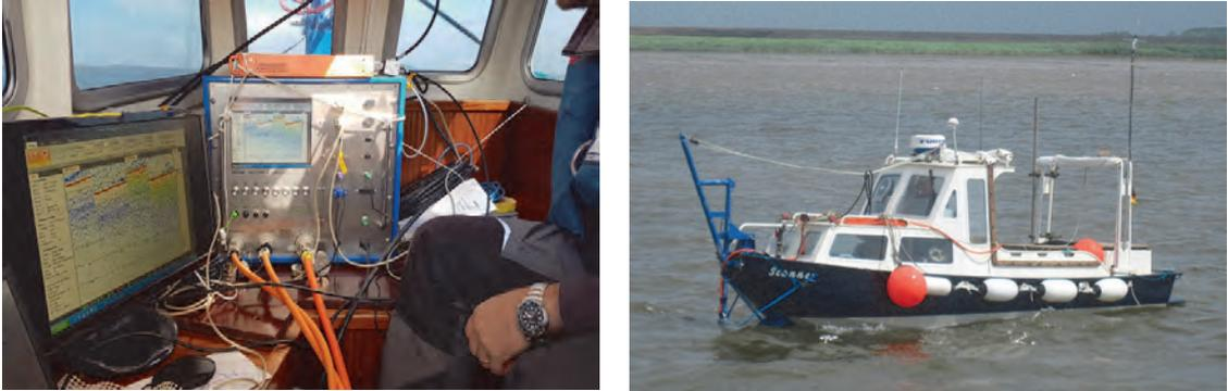
Abb. 2. Parametrisches Echolot SES 2000 Standard plus für die hydroakustischen Messungen zur Erfassung des Untergrundes an Bord des Arbeitsbootes „Scanner“.
