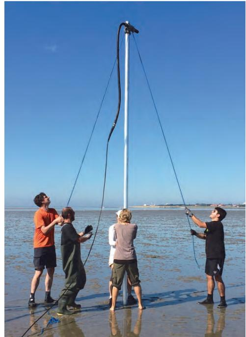
Abb. 3. a) elektrisches Vibrationsbohrgerät an Bord der Burchana (Foto: R. Capperucci) für die Unterwasserbohrungen und b) elektrisches Vibrationsbohrgerät für den Einsatz auf den Wattflächen (Foto: S. Wolters).
