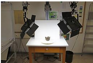
Auf einem Drehteller wird das Gefäß in mehreren Runden fotografiert, um so die Datenbasis für die Erstellung eines 3D-Modells zu gewinnen
